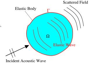
Compressible Fluid  $\Omega^c = IR^d \setminus \Omega \bigcup \Gamma$
