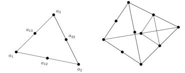
**Fig. 5.6** The finite element  $P_2(K)$ .
