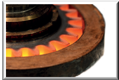
Induktionswärmebehandlung für ein Zahnrad
